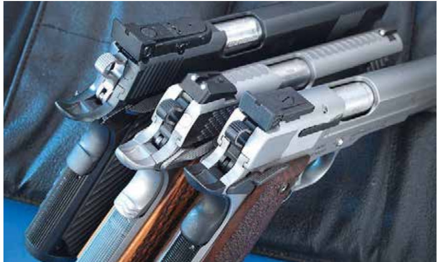
Das Aristocrat-Mikrometervisier der STI TM Series 6.0 (links) bietet drei schnell einstellbare Höhenpostionen. Die Tritium-Visierung der Kimber Raptor II lässt sich nur seitlich durch Klopfen justieren. Die Smith & Wesson SW 1911 Pro Series (rechts) kommt mit einer gängigen Mikrometerkimme im BoMar-Stil. Weniger üblich ist die außenliegende Auszieherkralle der S&W.
